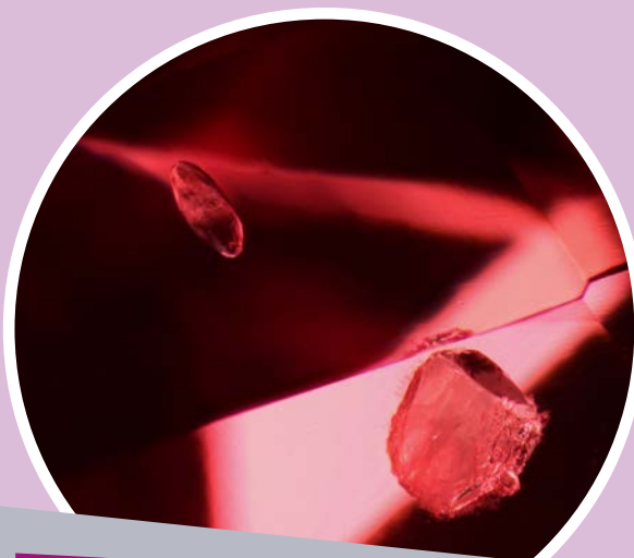
Включения доломита в шпинели Махенге весом 5,03 карата
