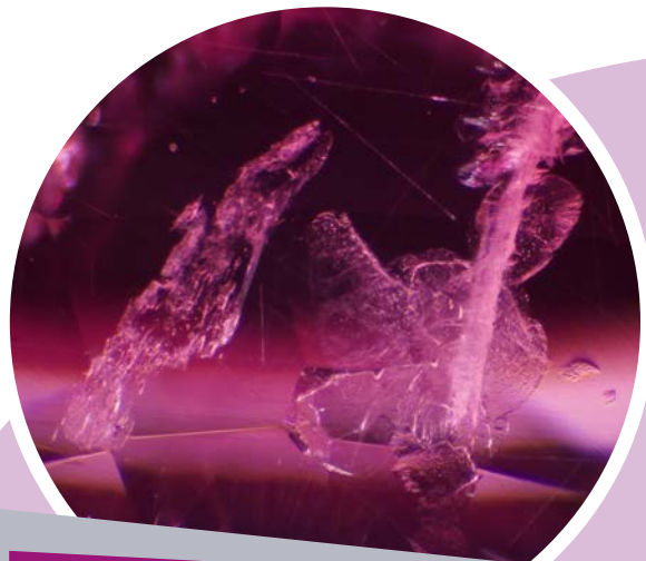
Включения частично трассированных игл и трещины в шпинели Махенге
